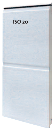
Die 20 mm starke Sektion besteht aus feuerverzinktem, doppelwandigem Stahlblech und hat einen FCKW-freien PUR-Hartschaumkern.
